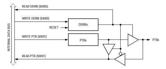
Figure 14-7. Port B I/O Circuit
