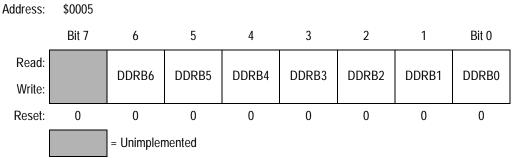
Figure 14-6. Data Direction Register B (DDRB)
