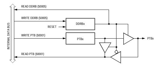
Figure 15-7. Port B I/O Circuit
