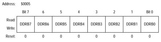
Figure 15-6. Data Direction Register B (DDRB)
